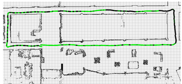
그림 10. 감지된 특징점에 따른 추정 로봇 궤적 (검정색: 특징점 0~1개, 녹색: 2개 이상 감지) Fig. 10. Robot estimated trajectory of the detected feature points( Black: feature point 0~1, Green: feature points 2 or more detection)
