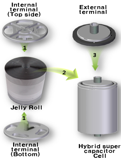
그림 1 Axial type 하이브리드 슈퍼커패시터 구조 Fig. 1 The structure of hybrid supercapacitor with axial type
