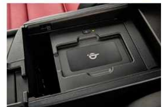
[그림 2] 자동차에 적용된 휴대용 기기를 위한 무선 충전 시스템 사례(자료 제공: 이성수(한국과학기술원))
