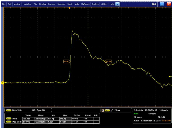
[그림 4] 펄스 발생기 PBG3 출력파형 측정 결과
