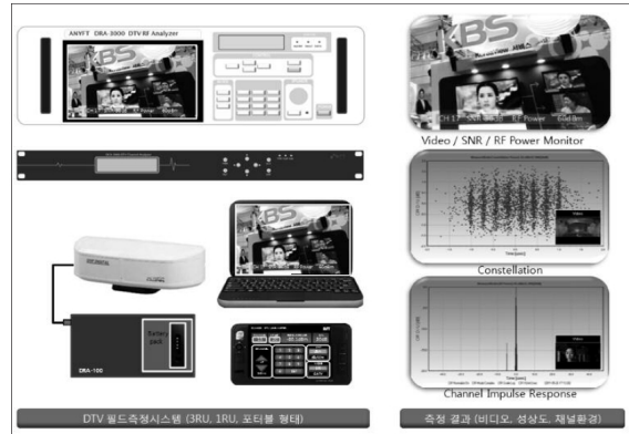
그림 6. DTV 필드 테스트를 위한 시스템 구성 및 측정 결과 예 Fig. 6. The system configuration for DTV field test and example of measurement result
