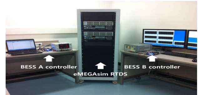
그림 8 인천대의 마이크로그리드 BESS 제어기 개발에 HILS 활용 예
