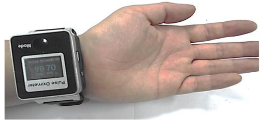
Fig. 2. Wrist type pulse and SpO 2 Sensor 그림 2. 손목 시계형 맥박 센서
