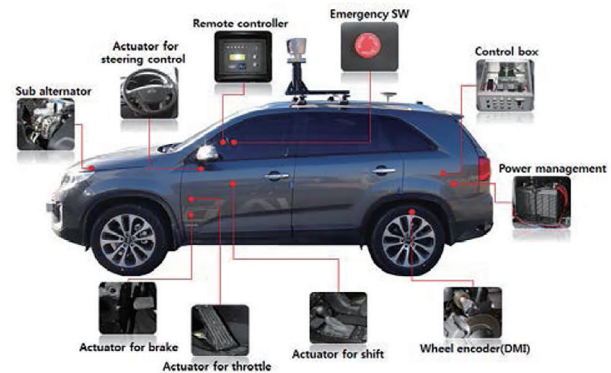
그림 2. 차량제어를 위한 H/W (출처 : ETRI 코파일럿 시스템-HW, [17])
