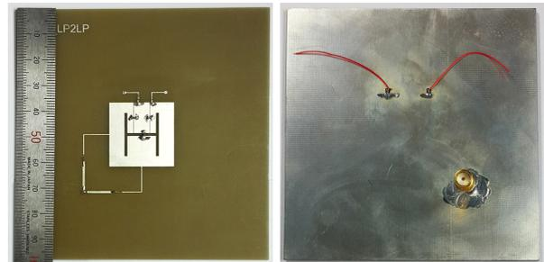
그림 5. 제작한 안테나 사진
