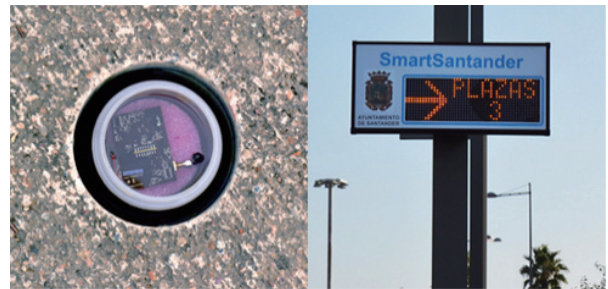
〈그림 9〉 스마트 센서와 주차정보 알림 시스템
