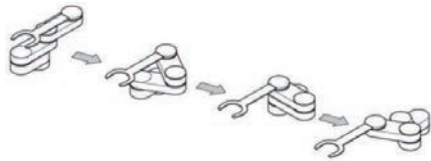
〈그림 5〉 반송 robot의 indexer
