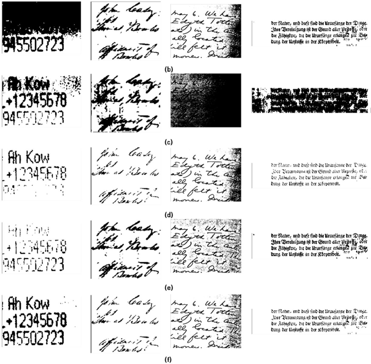
그림 5. (a) Otsu 방법, (b) Niblack 방법, (c) Sauvola 방법, (d) Jain 방법 (e) 제안된 방법
