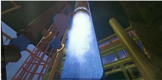
그림 6. 장비 내부의 유동 상태의 가시화
