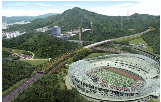
동탄 IC • IC형식 : 변형클로버 • 접속도로 : 국지도84호선 • 주요 구조물 - 교량 : 5개소 / 290m - 터널 : 3개소 / 930m
