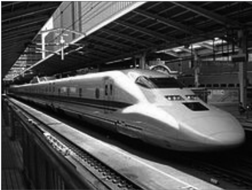
[그림 9] 923형 신칸센 전기궤도 종합 시험차
