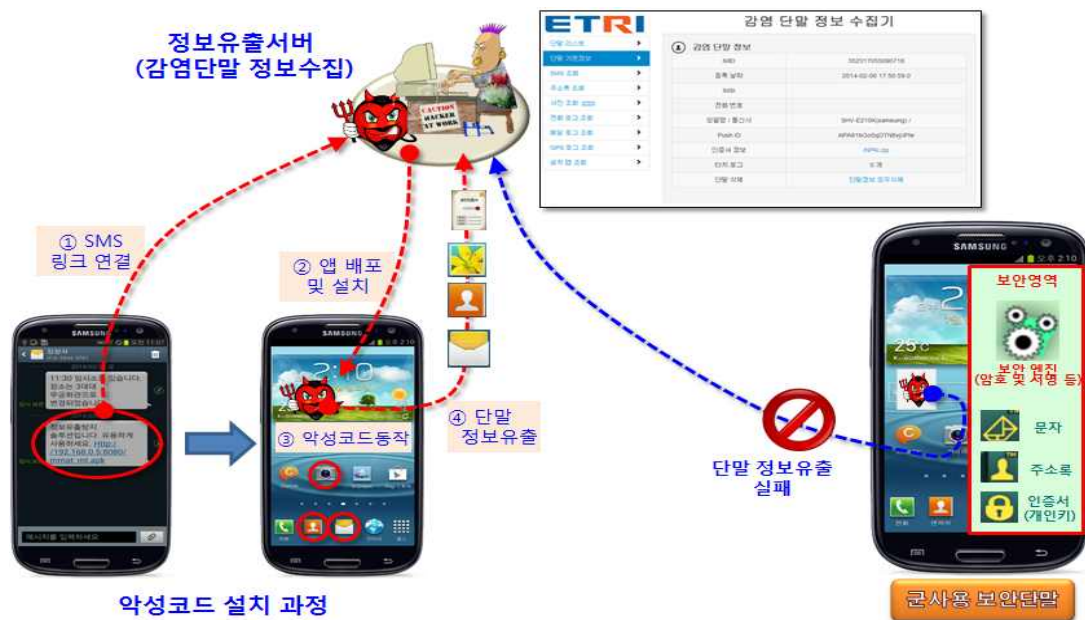
그림 6. 스미싱 기법에 의한 악성코드 배포 및 실행 과정
