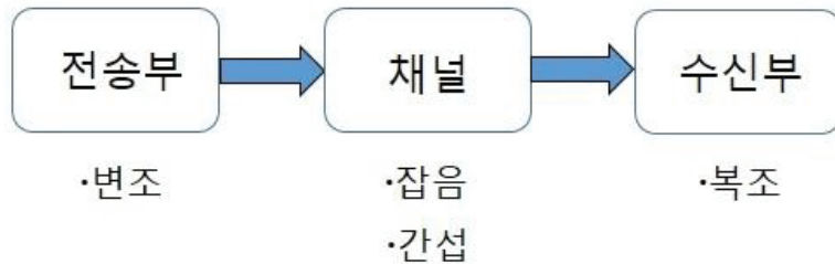
그림 2. 통신 시스템의 블록 다이어그램
