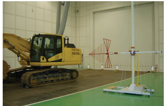
Fig. 5 Emission (EMI) test(Komatsu)
