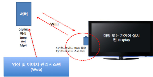
그림 1 안드로이드 기반 디지털 사이니지 시스템 구조 Fig. 1 Android-based digital signage system structure
