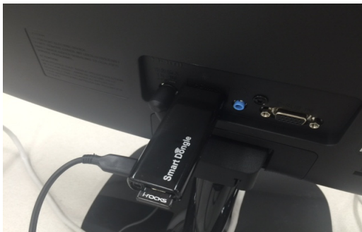
그림 2 안드로이드 Stick을 디스플레이 장치에 연결한 모습 Fig. 2 Connect your Android Stick figure on a display device
