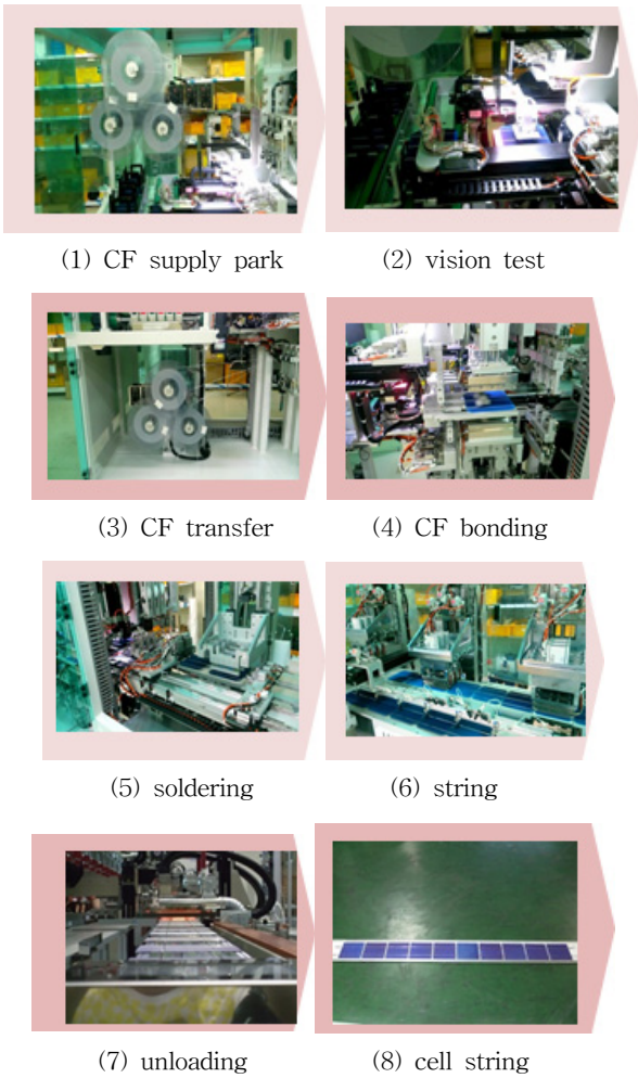
그림 1 CF 공정 순서 Fig. 1 CF bonding process
