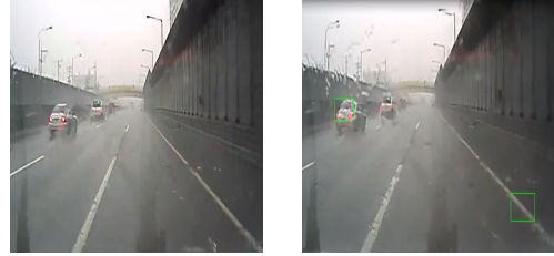
그림 2. (a)원본 영상, (b)GMM을 이용한 차량 검출 결과 Fig. 2. (a)original image, (b)result of vehicle detection using GMM
