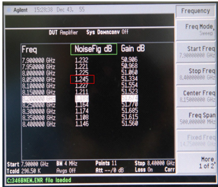
그림 12. 저잡음증폭장치의 잡음지수 시험결과 Fig. 12 NF test result of low noise amplifier
