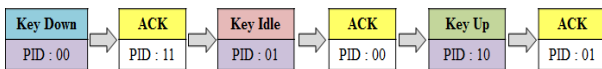
그림 6. 무선 키보드 키 입력 시 발생하는 패킷 Fig. 6. Packet generated when wireless keyboard key input.
