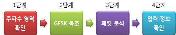
그림 2. 무선 키보드/마우스 신호 분석 단계 Fig. 2. Signal analysis step of wireless keyboard/mouse.
