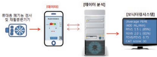
〈그림 4〉 개인용 폐기능 기기와 시스템 개요도
