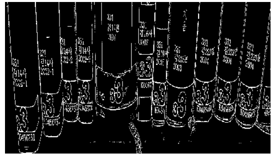
그림 3. 잡영 제거 후 적응형 이진화를 수행한 영상 Fig. 3. Result image after recognition and locally adaptive thresholding
