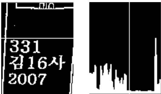
그림 7. 색상 검출기로 추출한 영상과 히스토그램 Fig. 7. Image using the color detector and histogram
