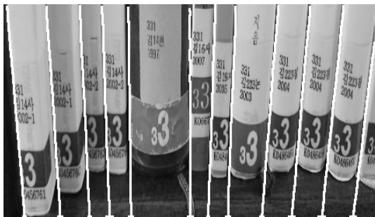
그림 4. Hough 변환으로 경계를 획득한 결과 Fig. 4. Boundary detection image using the Hough transform
