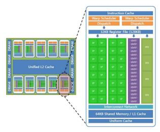
Fig. 1. NVIDIA's GPU architecture(Fermi)
