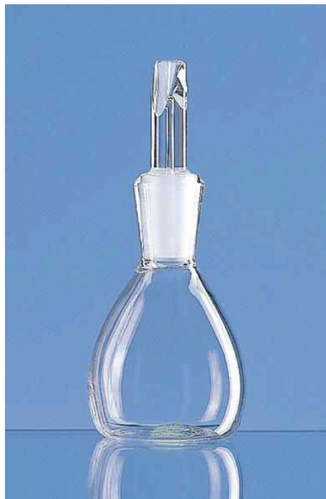
Fig. 1. 피크노미터(Pycnometer). 아래 쪽 병을 물로 가득 채운 다음 모세관이 달린 뚜껑을 살며시 닫으면 모세관의 끝부분 까지 물이 차오르도록 되어있다. 물을 가득 채운 다음 무게를 재면 물의 무게와 내부의 부피를 알 수 있고, 액체의 밀도와 분체의 밀도를 측정할 수 있다.
