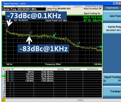
그림 5. 국부발진신호의 위상잡음 Fig. 5 Phase Noise of Local Oscillator
