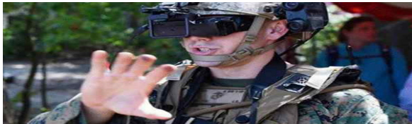
▶▶ 그림 6. 증강현실 훈련체계 (Augmented Immersive Team Training, AITT) 헬멧 장착 디스플레이
