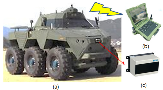
그림 7 (a) 실험 플랫폼, (b) 원격제어장치, (c) LD-MRS Fig. 7 (a) Experimental platform, (b) Remote control unit, (c) LD-MRS
