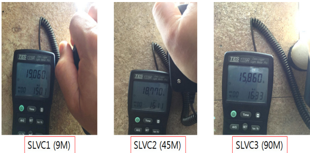
그림 14 밝기 보정 전 Lux 측정 결과 Fig 14 Before Brightness correction Lux Measurement Result
