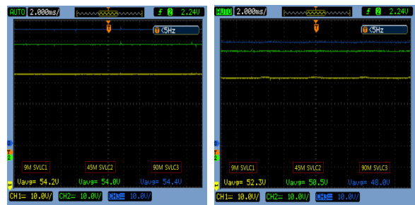
그림 12 거리에 따른 LED조명의 부하/ 무부하 상태 입력 전압 Fig 12 Depending on the distance Load/No Load Input Voltage
