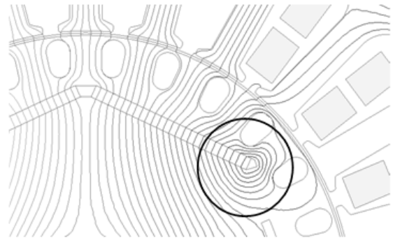
그림 5 영구자석의 누설 자속 Fig. 5 Leakage flux of permanent magnet
