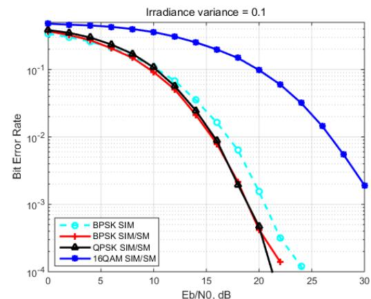
그림 3. 터뷸런스 채널에서 변조 방식에 따른 SIM/SIM의 BER 성능( $\sigma^2=0.1$ )
