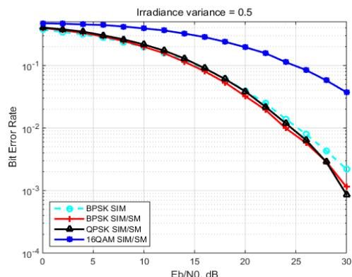
그림 5. 터뷸런스 채널에서 변조 방식에 따른 SIM/SIM의 BER 성능( $\sigma^2=0.5$ )
