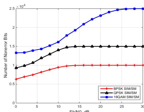
그림 6. 터뷸런스 채널에서 변조 방식에 따른 SIM/SIM의 수신한 비트의 개수( $\sigma^2=0.1$ )
