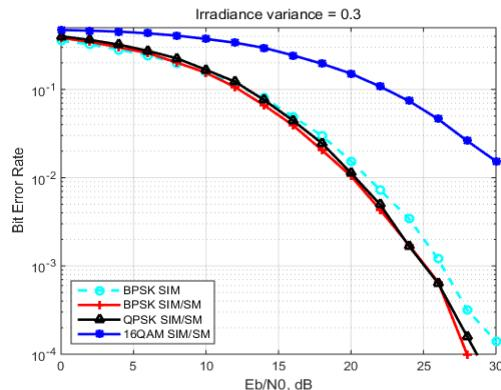
그림 4. 터뷸런스 채널에서 변조 방식에 따른 SIM/SIM의 BER 성능( $\sigma^2=0.3$ )
