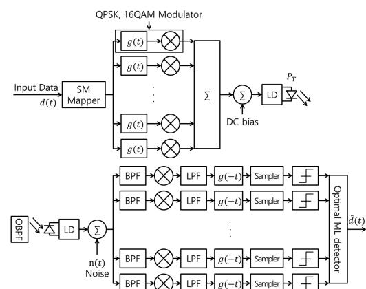
그림 1. 고차 변조방식을 적용한 SIM/SM 시스템의 블록 다이어그램
