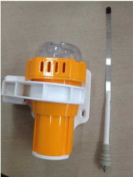
그림 6. VDR시스템과 연계된 EPIRB시스템
