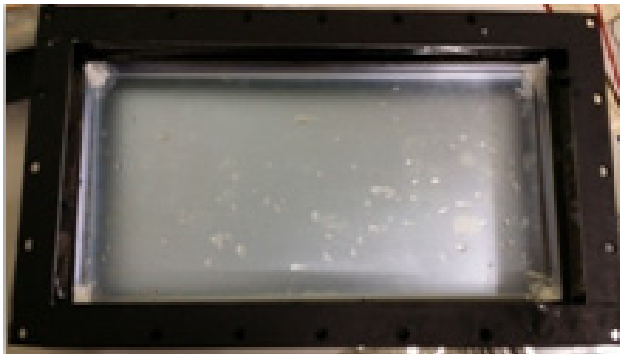
(c) 세트모듈의 방수용 케이스 그림 6. 개선 에너지블록 모듈의 방수시스템
