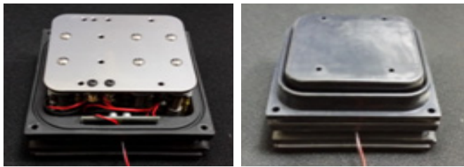
(a) 단위모듈 하부 방수용 케이스 (b) 단위모듈 상부 방수용 케이스
