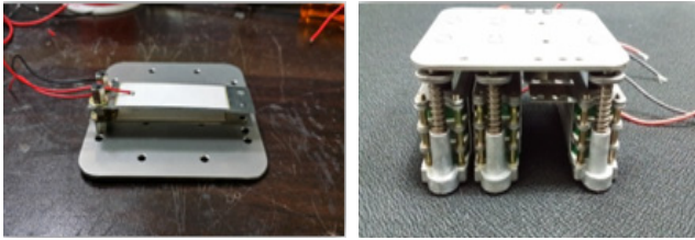
(a) 압전부 (b) 전자기부 그림 5. 개선된 단위모듈의 압전부 및 전자기부 형상
