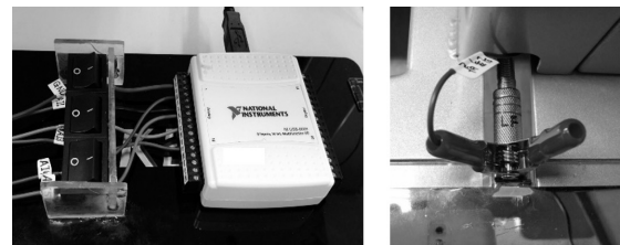
그림 2. 실시간 전압 측정 시스템 Fig. 2. Real-time voltage acquisition system.
