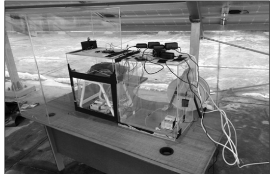
그림 9. 라돈 검출기 성능 실험 장치 Fig. 9. Experimental apparatus for performance evaluation of radon detector.
