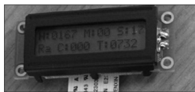
그림 5. 라돈 측정 결과 표시용 LCD 모듈 Fig. 5. LCD module displaying radon concentration data.
