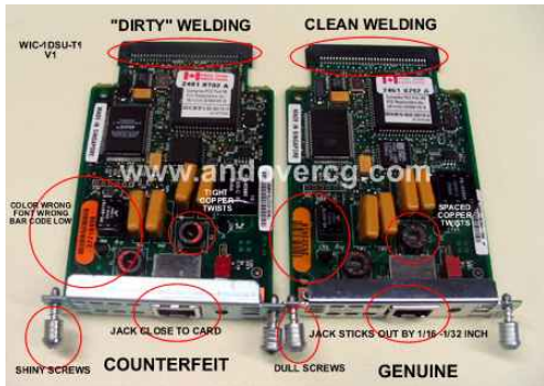
<그림 1> 시스코사 제품의 정품과 위조품 사진 [3, 4]
