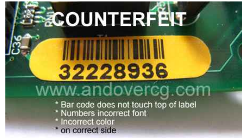
<그림 2> 시스코사 제품의 정품과 위조품 사진 [3, 4]
