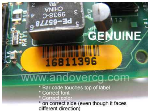
<그림 1> 시스코사 제품의 정품과 위조품 사진 [3, 4]
