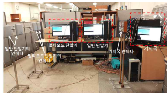
<그림 5> 멀티모드 단말기를 이용한 LSA 실험
