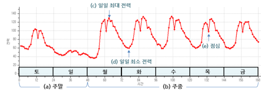
그림 2. 지역 특성에 따른 공단 분류 지역(녹산)의 전력 수요 패턴. (a) 주말 전력 수요, (b) 주중 전력 수요, (c) 일일 최대 전력, (d) 일일 최소 전력, (e) 점심 시간의 전력 수요 [x축 : 시간 ( |T_i| = 168 ), y축 : 전력 수요]
