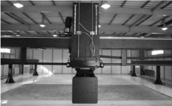
그림 17. 구현한 지면투과레이더 및 자동화된 측정 설비
