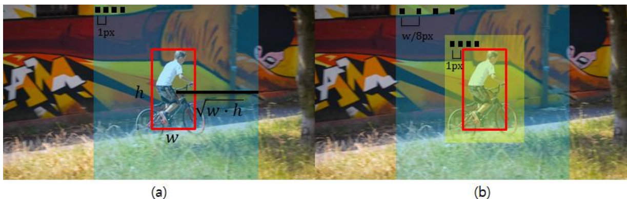
그림 2. (a) 기존 기법 [1,3] 에서의 탐색 영역 (b) 제안하는 탐색 영역 Fig. 2. (a) Search region of previous algorithm [1,3] (b) Proposed search region
