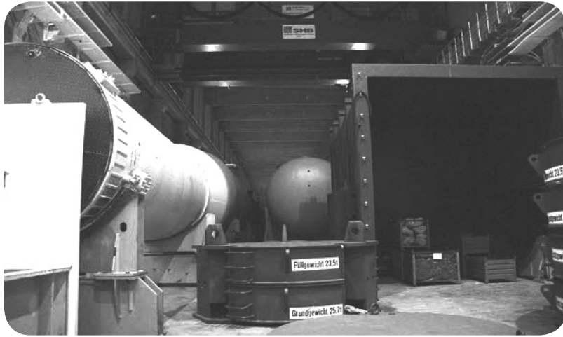
독일 그라이프스발트 원전 안에 봉인해 저장하고 있는 원전 설비·부품들. 독일의 폐지 조치의 기본 전략은 즉시 해체 철거를 원칙으로 하여 사이트의 그린필드(Green field)화, 해체 폐기물의 리사이클, 방사성폐기물의 심지(深地) 처분 등이다.
