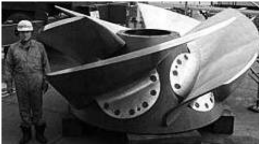
〈그림 5〉 수도권외곽방수로 펌프인펠라(좌) 및 배수통관(우)
