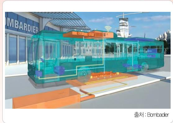
그림 5 Bombardier의 무선충전 버스 투시도
