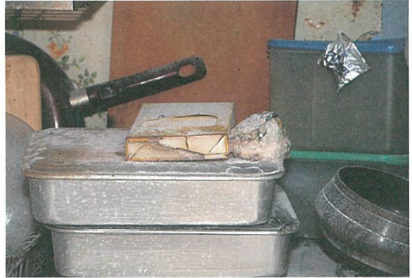
[사진2] LPG 확산 폭발 현장 열변형 흔적이 낮은 곳에서 주로 발견된다.
