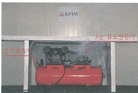
[그림 9] 1상 결상에 의한 3상 유도전동기의 상황
