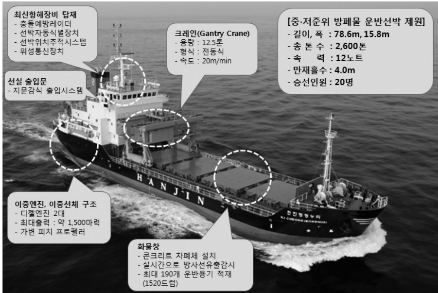
방폐물 운반 전용 선박-청정누리호. 방폐물을 전문적으로 운반하는 배수량 2,600톤급 선박으로 한반도 연근해에서 특수한 환경에서 발생할 수 있는 격랑에 충분히 견딜 수 있도록 이중 선체로 제작되었다.
