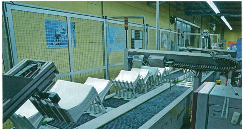
콘젤라는 소유하고 있는 다른 사철기와 마찬가지로 벤추라 MC 160을 2개의 벤추라 커넥트 시스템과 통합했다. 접지물은 미리 정합 과정을 거쳐 적재된 후 1번의 사철 과정을 진행하게 된다.
