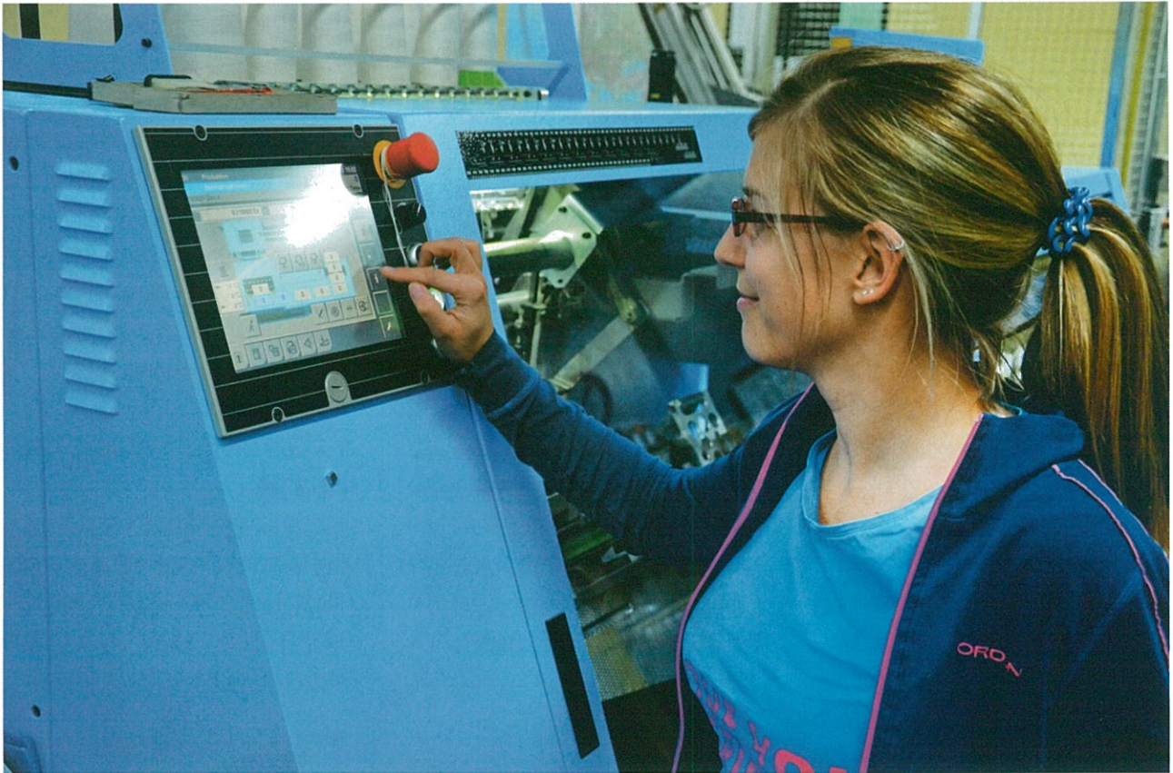
이미 입증된 작업 또는 설치 마법사 같은 터치스크린의 시각화 덕분에 콘젤라의 기장은 더 빠르고 쉽게 작업을 전환하는 것이 가능해졌다.
