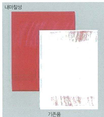
〈그림1〉 2kg 하중 / 60회 왕복 내마찰성 평가결과
